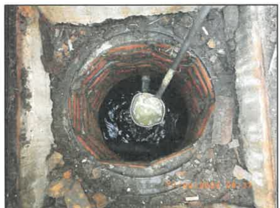
(2) ป้อนตรวจสอบคุณภาพน้ำทิ้งหลังจากจากระบบบำบัดน้ำเสีย ตึก A
